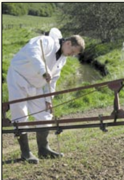
Nastavení správné výšky postřikového rámu nad porostem je důležité pro kvalitní práci
