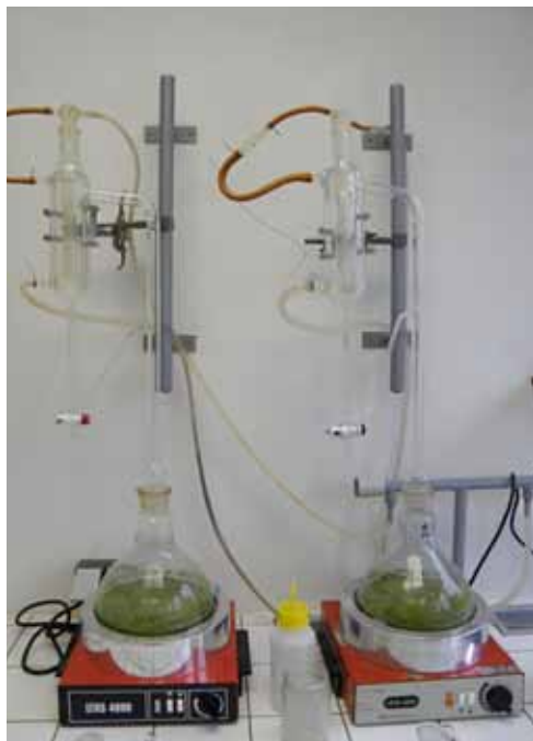
Obr. 9: Aparatura pro izolaci chmelových silic destilační metodou
